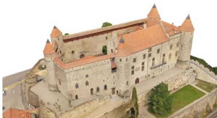
Modèle 3D photogrammétrique élaboré sur la base de plus de 3000 photos aériennes par drone et constitué de plus de 33 millions de polygones
